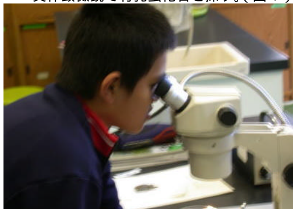
図4 双眼実体顕微鏡で観察している様子 有孔虫化石を面相筆を使ってプレパラートに拾い出し、サンプルを作成する。 (図5)
