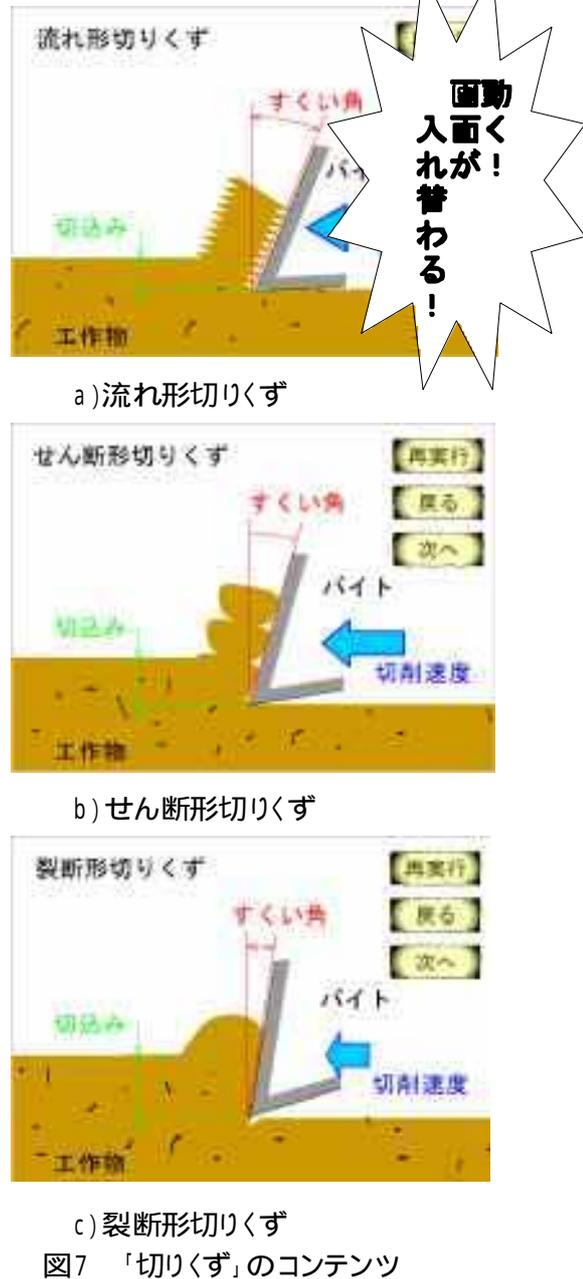
図7 「切りくず」のコンテンツ
