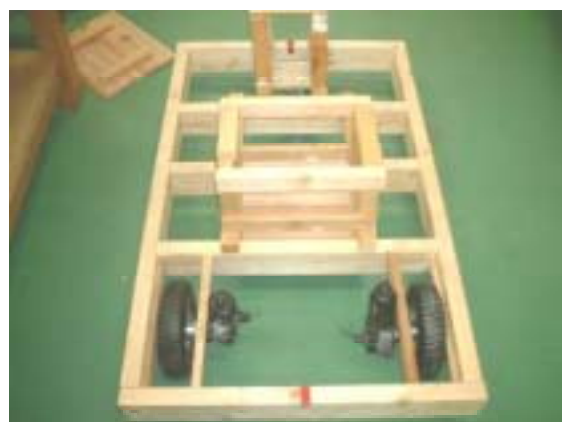
図10 電動カートの基本構造(2×4材フレーム)
