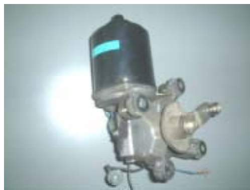
図11 動力として使用するワイパーモータ
