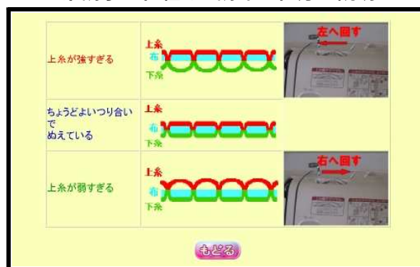
図6 説明図を取り入れた糸調子の仕組みと調節の仕方の説明
