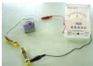
図5 検流計を用いた電池チェッカー
