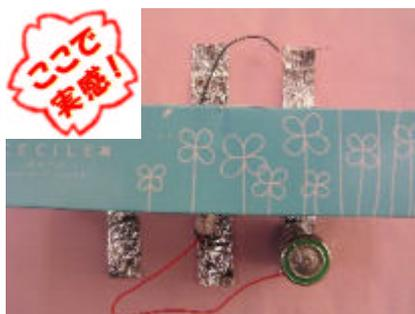
乾電池のマイナス極、箱の内側に出した導線をアルミ箔の帯に接触させ、豆電球がつくか確認させる。
