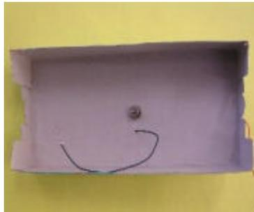
くぎ、鉛筆などを使いソケットと導線を通す穴を開ける。導線用の穴はソケットの下にあける。
