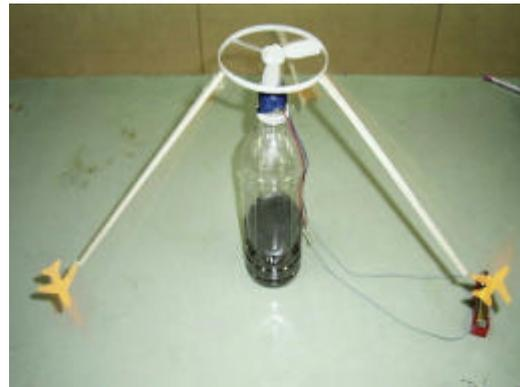
光電池に、当たる光の強さによって、回路に流れる電流の強さが変わり、モーターの回転の速さが変わることを実感させることができる。
