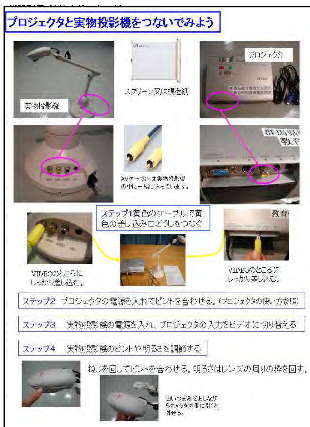
図4 プロジェクタと実物投影機の接続方法を示した機器操作ガイドの例
