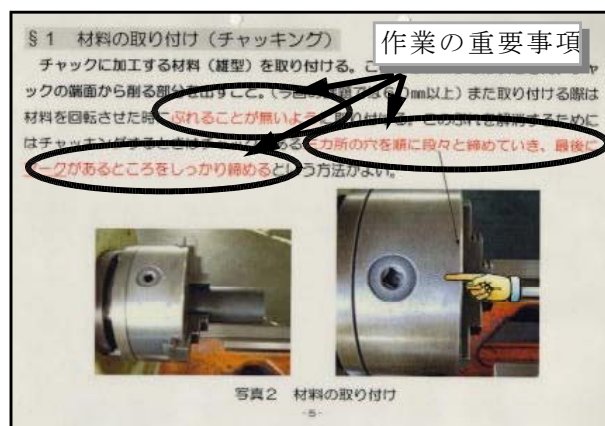
図6 旋盤作業のポイント（材料の取り付け）
