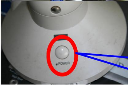
実物投影機の電源スイッチです。電源コンセントと接続ケーブルが差し込まれているかを確認してから押しましょう。スイッチを入れると、POWERの隣が赤く光ります。
