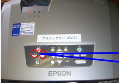
コンピュータと実物投影機の切り替えボタンです。左がコンピュータ、右が実物投影機です。使う機器のボタンを押しましょう。
