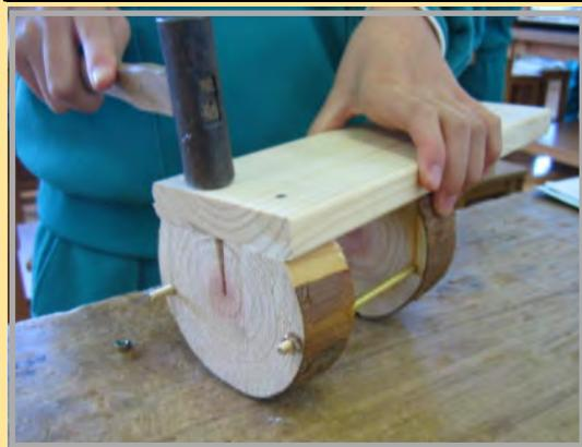
基板(1×4材)に釘の下穴を十分にあげてから接合する。
