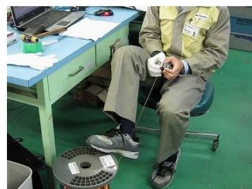
図7 ブラシレスモータ の試作(コイル巻き)
